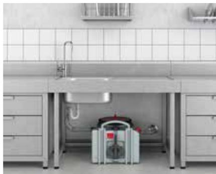
ACO LipuMobil-P 0.8 è stato sviluppato appositamente per l'uso in snack bar, bistrot, piccoli ristoranti fast food e food truck. Il piccolo separatore per installazioni mobili (testato secondo DIN EN 1825) si caratterizza per le sue dimensioni ottimizzate, l'altezza di ingresso ridotta e la portata massima consentita fino a 0,8 l/s.
