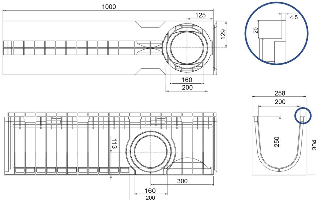
Tenuta all'acqua: per assicurare la tenuta stagna delle canalette, si consiglia l'utilizzo di un adesivo sigillante bituminoso. A garanzia completa e duratura dell'assenza di perdite attraverso i giunti delle canalette, si può provvedere alla saldatura a caldo dei giunti stessi.
