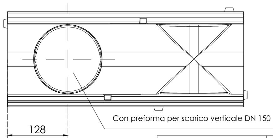
Con preforma per scarico verticale DN 150
